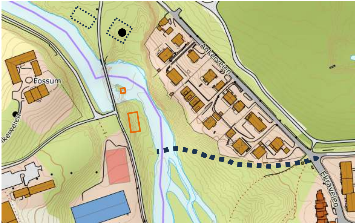
Figur FJ9: Norgeskart.no med overtegnnet trasé (svarte prikker) til vei og bru fra før Hammerbrua. Hus til stanghammer (brune linjer), masovnen, kullageret (svarte linjer).
