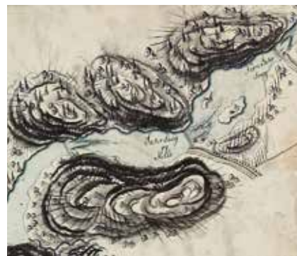
Elvestrekningen ved Jar. Øvre Jar sag (midt på bildet) ligger ovenfor mølla, og rett nedenfor en demning. Det er også tegnet en demning ved Øraker hvor Jarfyllingen ligger i dag. Vannspeilene bak demningene dekker elveslettene. Den øverste demningen ville vært viktig for tømmerfløting over det som i dag er en meget steinete elvestrekning nord for Bærumsveien. Øverst til høyre, Nedre Jar sag og kjøreveien utfra sagbruket. Utsnitt fra krigsskolekadettens Croqui over Elven fra Bogstad til Lysager. [Nasjonalbiblioteket Kart 3555. no-nb_krt_00391, ca. 1808]
